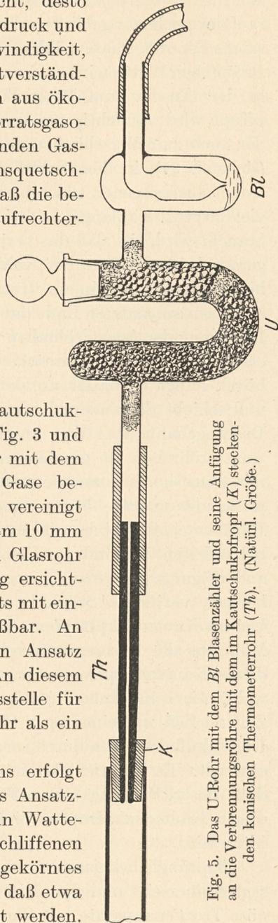
Fig. 5. Das U-Rohr mit dem *Bl* Blasenähler und seine Anfüng an die Verbrennungsröhre mit dem im Kautschukpfropf (*K*) stecken- den konischen Thermometerrohr (*Th*). (Natürl. Größe.)
