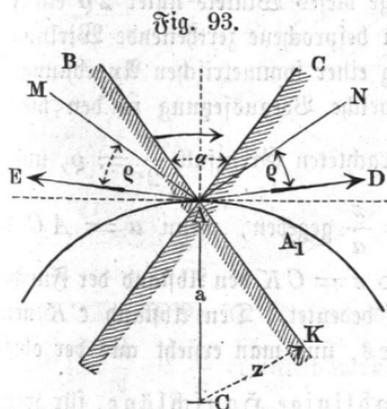
durch  $AC$  ein Hausschlag des fest darunter liegenden Bodensteines dargestellt sein, und es werde zunächst der Einfachheit halber angenommen, daß diese Hausschläge geradlinig ausgeführt seien. Stellt man sich die Umdrehung des Läufers in der Richtung des Pfeiles vor, so wird hierdurch auf ein im Kreuzungspunkte  $A$  liegendes Korn eine Wirkung ausgeübt, welche wesentlich von der Größe des Kreuzungswinkels  $BAC$  der beiden Furchen in  $A$  abhängig ist. Wenn dieser
