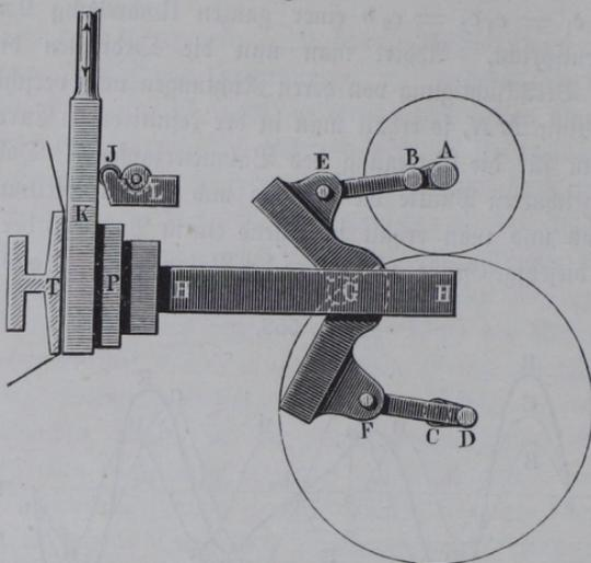
Reliefform aufgenommene Farbe auf das über *T* gespannte Zeug zu drucken. Hierzu ist daher erforderlich, daß die Druckplatte *P* aus ihrer hintersten Lage abwechselnd einen kleineren Vorschub bis an das Chassis *K* und dann einen größeren Vorschub bis an den Drucksisch *T* erlangt.
