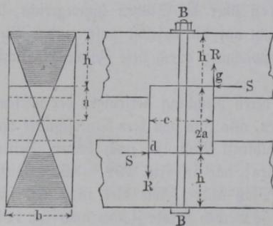
Bezeichnet hier wieder, Fig. 206,  $b$  die Breite und  $h$  die Höhe eines der Längshölzer an der durch einen Klotz verschwächten Stelle und  $2a$  die Höhe dieses Klotzes, so hat man hier die halbe reducirte Querschnittsfläche nach der Figur zu
