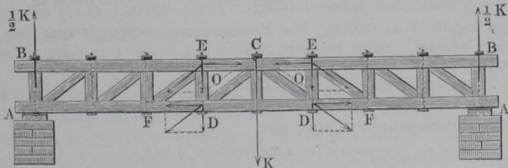
noch Streben  $CD$  und  $EF$  an, und setzt auch wohl Kreuz- oder Gegenstreben ein, so daß der Zwischenraum zwischen je zwei Bolzen durch ein sogenanntes Andreaskreuz ausgefüllt ist. Derartige Constructionen sind wie die Fachwerke zu beurtheilen, über welche weiter unten das Nähere angegeben ist.
