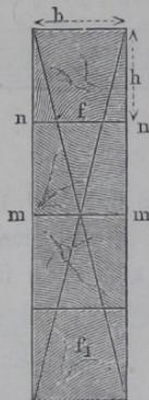
müssen, je größer die Verticalkraft  $V$ , d. h. je größer die Belastung  $K$  und je kleiner die Länge  $l$  des Balkens ist, über welche sich doch die Schubkraft vertheilt. Die Zähne müssen aber auch eine bestimmte Tiefe  $cd = \delta$ , Fig. 203, erhalten, so daß der spezifische Druck auf die verticale Stoßfläche
