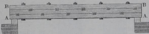
Balken nach den Figuren 198 und 199 mit schrägen oder geraden gegen einander passenden Zähnen versehen, welche sich einer Verschiebung entgegensetzen. Außerdem pflegt man durch übergeschobene Bänder, Fig. 196, oder durchgezogene Schraubenbolzen, Fig. 197, eine Trennung der Balken
