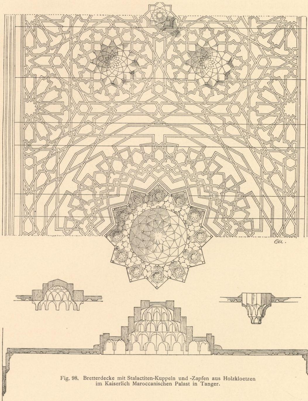
Fig. 98. Bretterdecke mit Stalactiten-Kuppeln und -Zapfen aus Holzkloetzen
