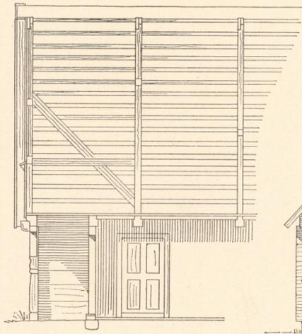
Abb. 2. Schnitt durch den Giebel.
