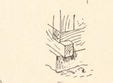
Abb. 23. Verbindung an der Schwelle des Wohnhauses.
