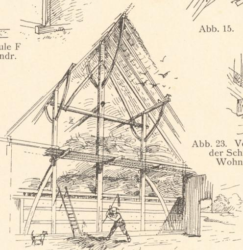
Abb. 21. Oberes Ende d. Firstsäule. Abb. 22. Ansicht der nördl. Tennenwand mit Firstsäule.
