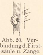
Abb. 20. Verbindung d. Firstsäule u. Zange.
