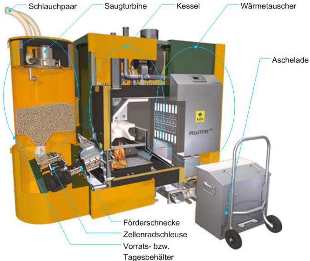
**Abb. 5-2 Heizkessel mit Tagesbehälter [7]**
