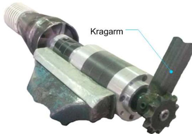
**Abb. 5-4 Planetengetriebe mit Lüfterrad und konischem Adapter**
