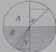
parallelplatte Fig. 15, so sehen wir ohne Weiteres, dass die durch die zweite Planfläche hervorgebrachte Dispersion die Dispersion der ersten Planfläche genau aufhebt.
