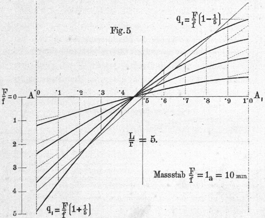
Kolbenweges  $AA_1$  die Ordinaten für  $\frac{F}{f} = 1$  nach der Tabelle auf der vorigen Seite im Maßstabe  $\frac{F}{f} = 1a = 1 \text{ Centimeter}$  aufgetragen und die erhaltenen Punkte verbunden wurden. Durch Umschlagen mit dem Zirkel ergaben sich die Beschleunigungscurven für die weiteren Werthe von  $\frac{F}{f} = 2$  und mehr.
