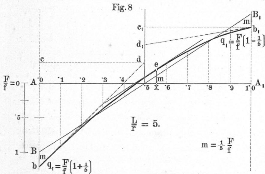
Wird noch berücksichtigt, dass für die Kolbenlage bei  $90^\circ$ , Punkt  $x$  der Fig. 8, die Tangente der Curve parallel der bereits gezogenen Geraden  $BB_1$  und in einer Höhe  $e$  läuft, deren Ordinate  $= m$  dem Unterschiede  $Bb$  ist, so kann nun die Curve mit großer Sicherheit diesen Tangenten entlang gezogen werden.
