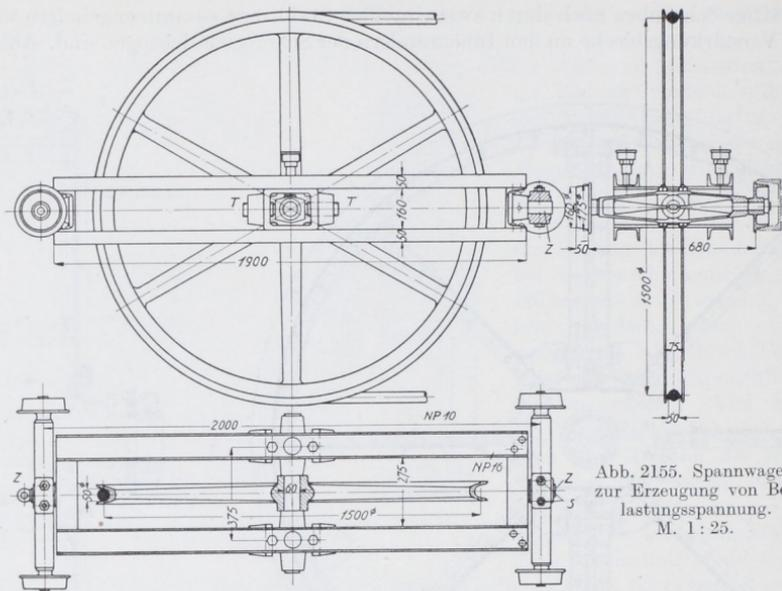
Abb. 2155. Spannwagen zur Erzeugung von Belastungsspannung.
