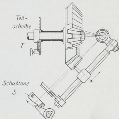
Abb. 1945. Hobeln von Kegelradzähnen nach einer Schablone.
