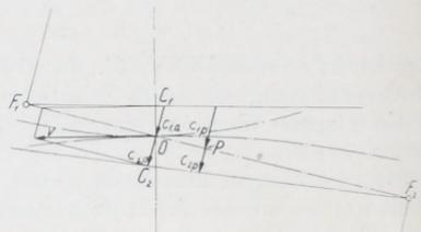
Abb. 1880. Ermittlung der Gleitgeschwindigkeiten bei Evolventenverzahnungen.
