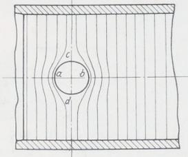
Abb. 1765. Kraftlinienverlauf in einem Zylinder mit einer Aussparung.
