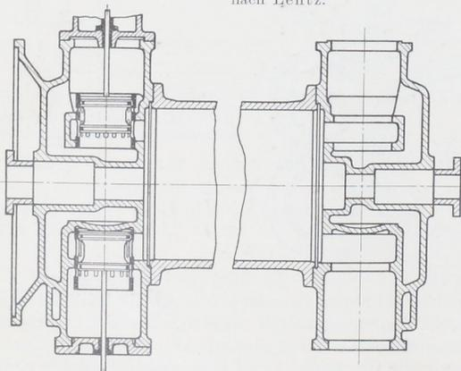
Abb. 1750. Zylinder mit Kolbenventilsteuerung.
