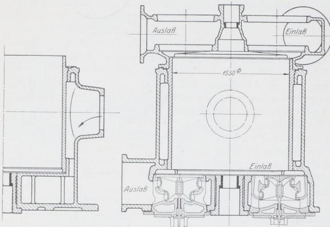
Abb. 1748. Zylinder mit Ventilsteuerung für stehende Maschinen.
