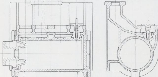
Abb. 1749. Lokomotivzylinder mit unmittelbar eingearbeiteten Ventilsitzen nach Lentz.
