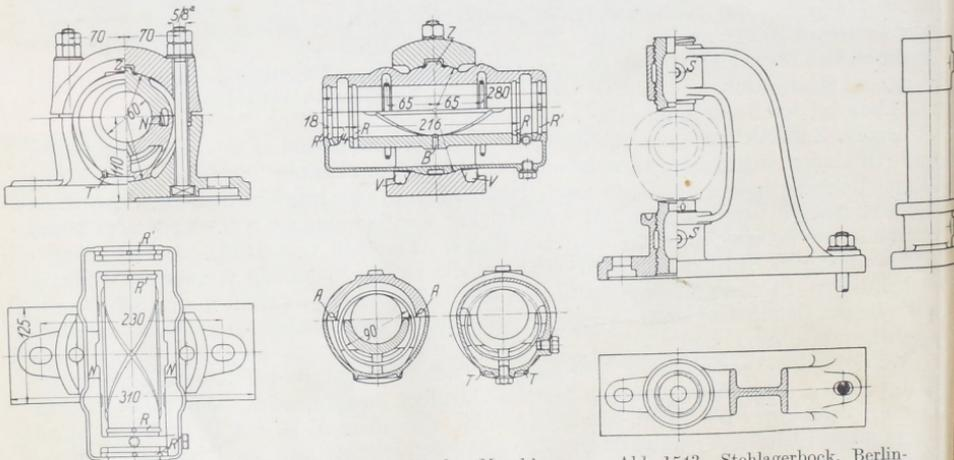
Abb. 1542. Bomag-Sparlager der Berlin-Anhaltischen Maschinenbau A.-G., Dessau. M. 1 : 8.
