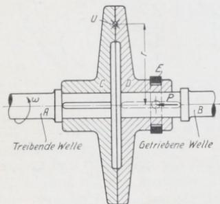
Abb. 1429. Schema einer Reibkupplung.
