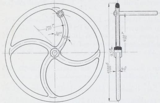
Abb. 2188. Schwungrad für von Hand betriebene Maschinen. M. 1:20.
