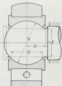
$a$  und  $d_0$  ergeben sich aus der Aufzeichnung, bei welcher der seitliche Ausschlag der Stange zu berücksichtigen und auf eine gute Abrundung am Übergang vom Zapfen zur Welle zu achten ist. Als Anhalt kann  $d_0 = 0,6 d$  dienen.
