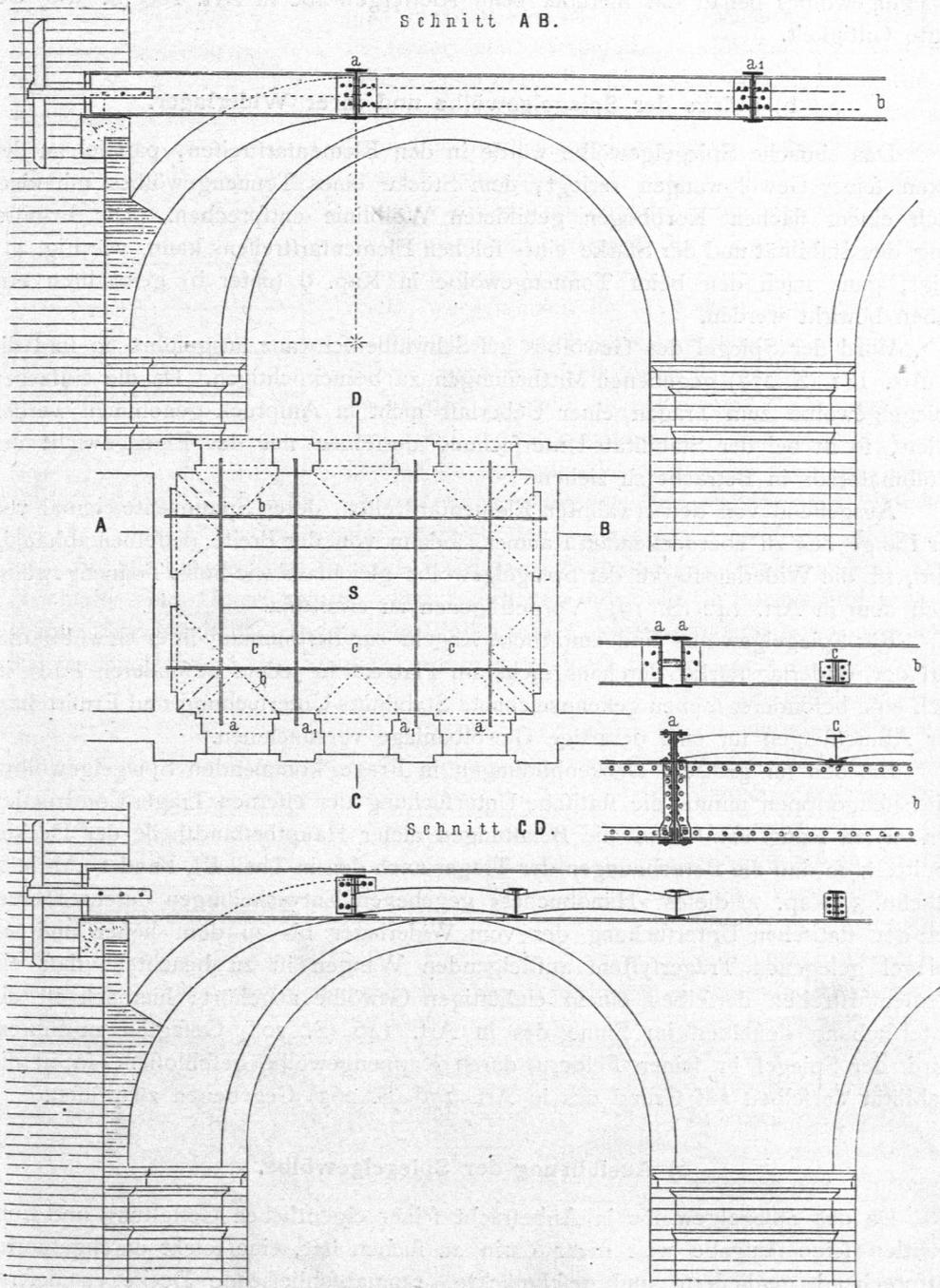
oder mit den Hauptträgern *a* durch Winkeleisen und Nietung, bzw. Verschraubung verbunden. Die durch Einschaltung dieser Nebenträger entstehenden, sehr schmalen Gewölbefelder des Spiegels werden mit ganz flachen Kappengewölben, bzw. schieftrechten Gewölben geschlossen, welchen nur etwa 2 cm Stich gegeben wird.
