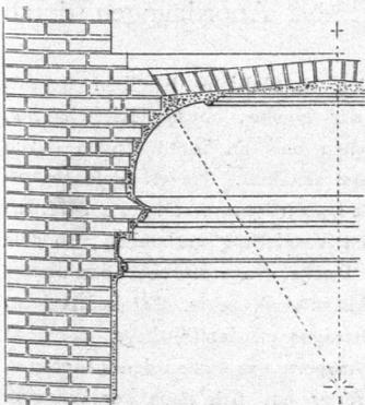
gewölbes als Wangentheile eines Klostersgewölbes auszuführen sind, werden fachgemäß die unteren Schichten derselben, so weit thunlich ist, vorgekragt (Fig. 413), um hierdurch die Weite der eigentlichen Wölbung möglichst zu vermindern. Die in der Abbildung für einen Gewölbstreifen von der Tiefe gleich der Längeneinheit eingetragene Mittellinie des Druckes mit dem möglichst kleinsten Gewölbschub  $H$  giebt über die statischen Verhältnisse des Gewölbekörpers näheren Aufschluss.
