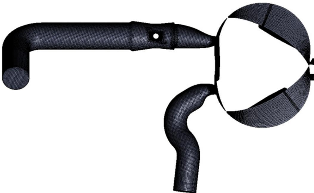
Abbildung 43: 3 Kammer Berechnungsdomäne
