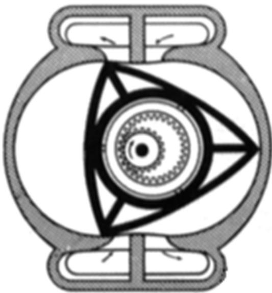
**1943 Maillard:** Maillard baute einen Kompressor nach Britischem Patent mit einem Übersetzungsverhältnis von 2:3. Die Form des Gehäuses ist von der Hypermetrochoide abgeleitet. Aufgrund von Dichtheitsproblemen konnte diese Bauweise nicht kommerziell verwendet werden.
