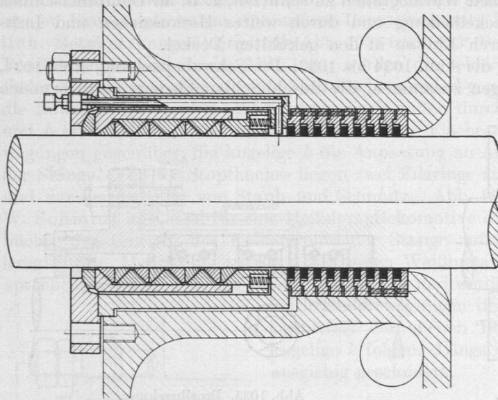
Abb. 1037. Großgasmaschinendichtung der Maschinenfabrik Augsburg-Nürnberg.
