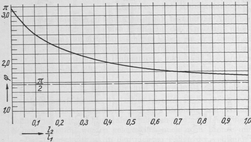
Abb. 1006. Werte für  $\varphi$  in Abhängigkeit von  $\frac{l_2}{l_1}$ .
