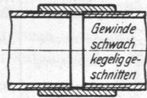
Abb. 651. Gasrohrmuffe.
