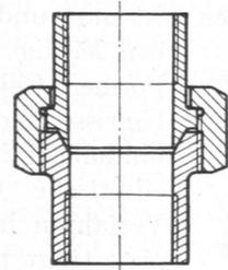
Abb. 664. Rohrverschraubung.
