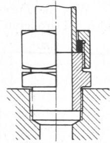
Abb. 665. Rohranschluß mittels Doppelnutten.
