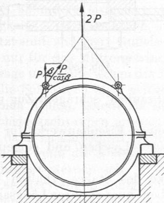
Abb. 432. Aufhängung eines Dynamogehäuses mittels zweier Ösen.
