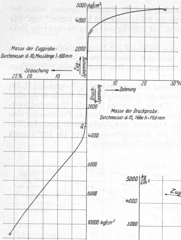
Abb. 128. Zug- und Druckversuch an Messing (Verfasser).
