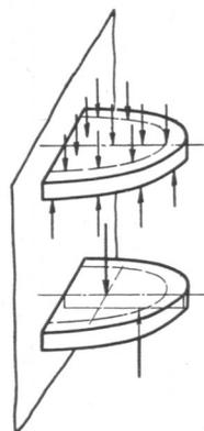
Abb. 70. Zur Berechnung ebener Platten nach Bach.
