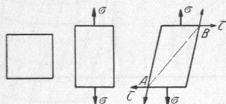
Abb. 47—49. Zur Zusammensetzung von Längs- und Schubspannungen.
