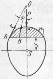
Abb. 42. Zur Ermittlung der Schubspannungen.
