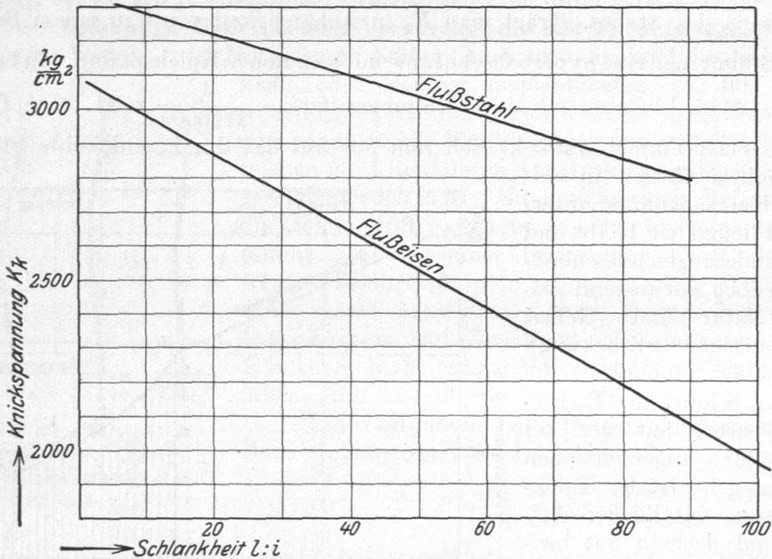
Abb. 21. Knickspannungen in Abhängigkeit von der Schlankheit an Flußeisen und -stahl.
