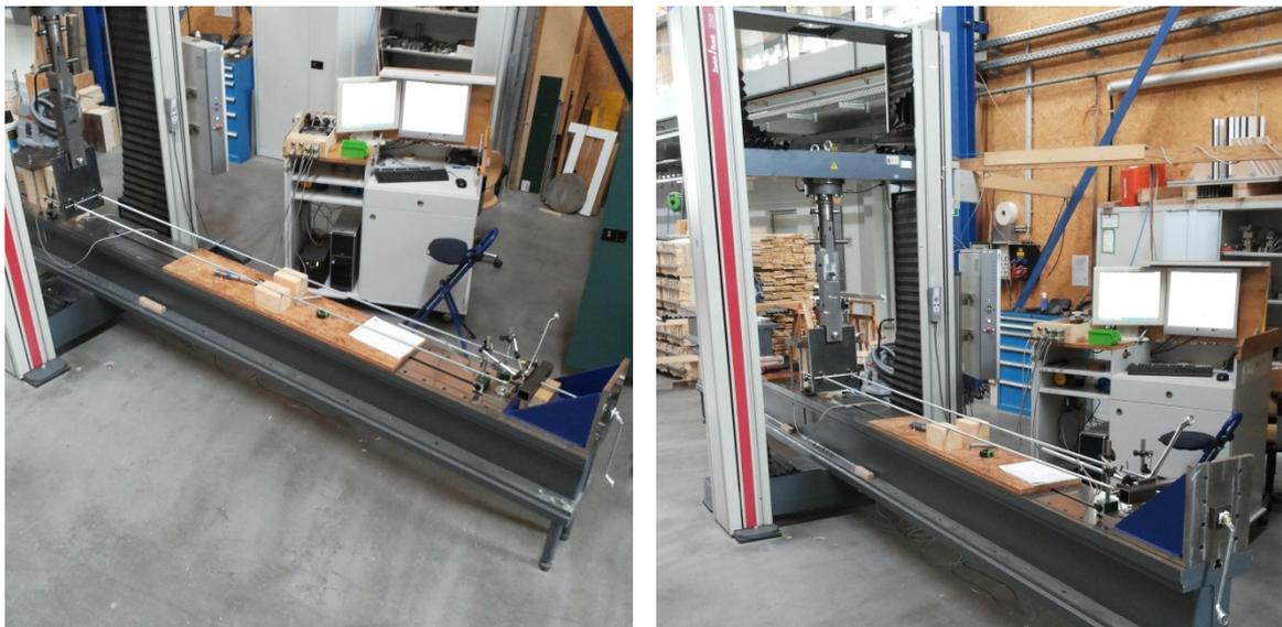
*Abbildung 3.12: Versuchsaufbau - Vorversuch V12 - Herausziehen*
