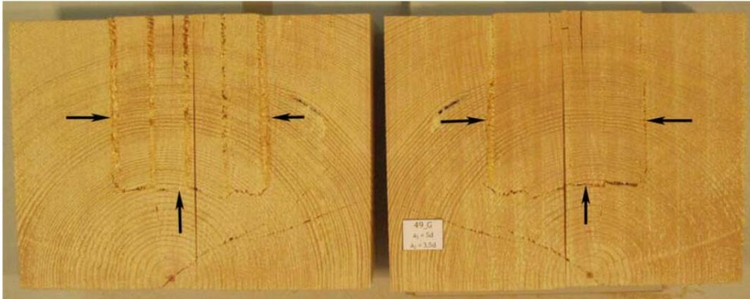
Abbildung 2.6: Blockscherversagen von axial beanspruchten Schrauben [16]
