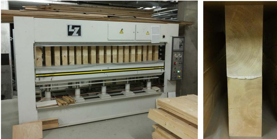
*Abbildung 4.2: Prüfkörper in der hydraulischen Presse*
