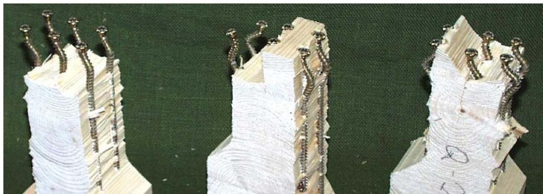
**Abbildung 2.5: Knickversagen bei Druckbelasteten Schrauben [34]**
