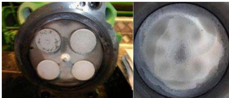
**Abbildung 65:** Brennraumablagerungen an Zylinderkopf (links) und Kolben eines Jenbacher BR6 Motors
