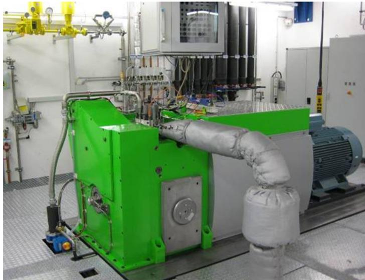
**Abbildung 12:** Einzylinder-Forschungsmotor Baureihe 4
