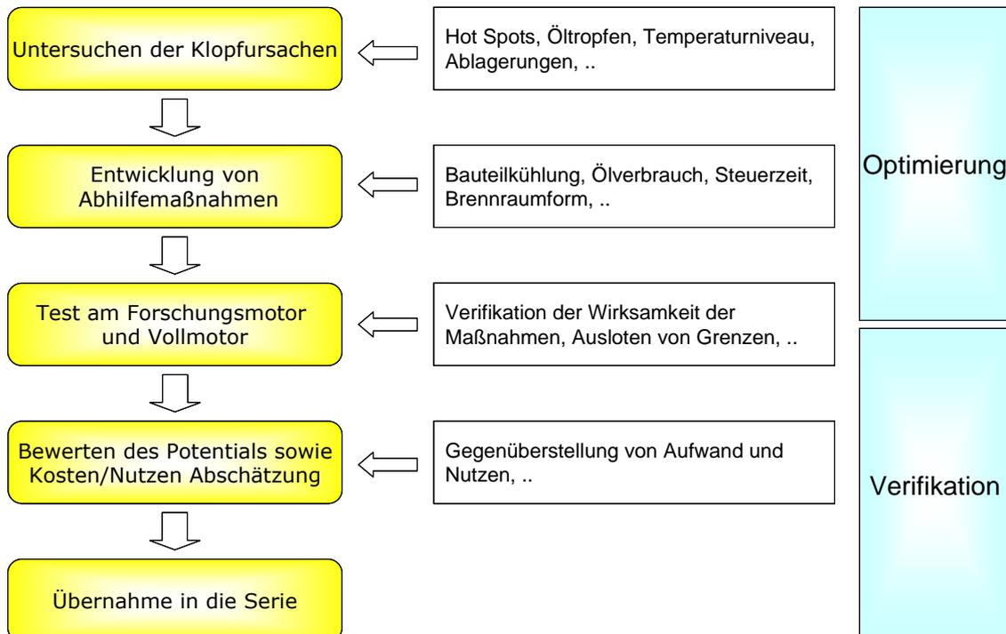
**Abbildung 15:** Ablaufschema bei der Optimierung des Klopfverhaltens
