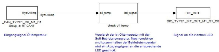
Abbildung 8.5.: Blockschaltbild des Zustandes „Temperaturüberwachung Hydrauliköl“,
