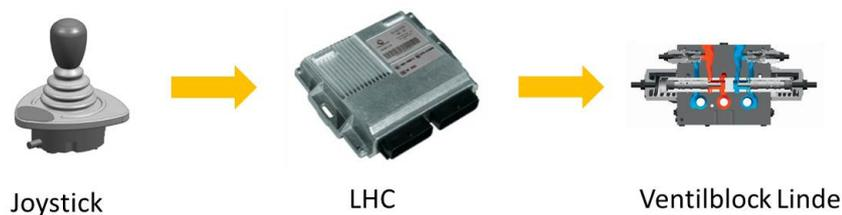
**Abbildung 4.2.:** Bedienung der Zusatzhydraulik
