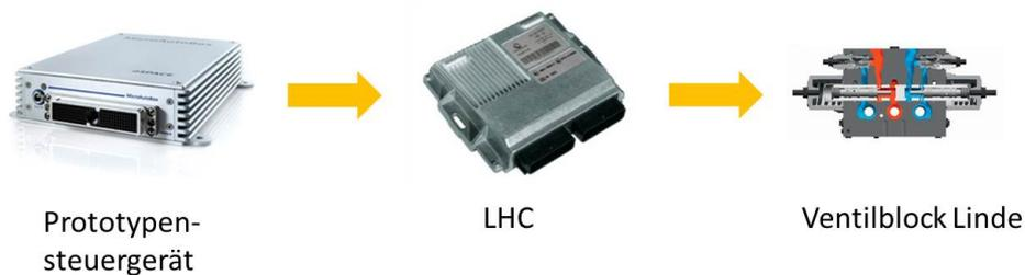
**Abbildung 4.3.:** Bedienung der Zusatzhydraulik über das Prototypensteuergerät
