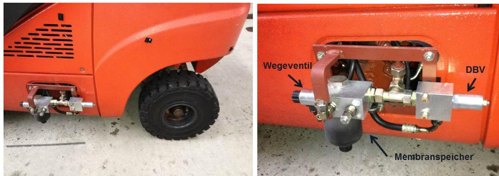
(a) Seitlich befestigter Hydraulikkreislauf
