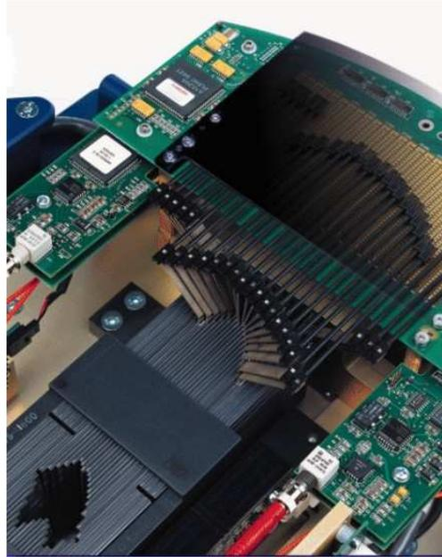
**Abbildung 3.2:** Micro-MLC (Brainlab m3) ohne Abdeckung. In der linken unteren Ecke des Bildes ist das von den Lamellen geformte irreguläre Feld zu sehen, rechts oben die Spindeln zur Bewegung der Lamellen.
