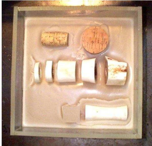
**Abbildung 3.5:** Wachsphantom (Eigenkonstruktion) in einer Plexiglaswanne vor der Auffüllung mit Wachs. Zu erkennen sind die eingelegten Korkteile und Knochen zur Nachbildung von Gewebehomogenitäten.
