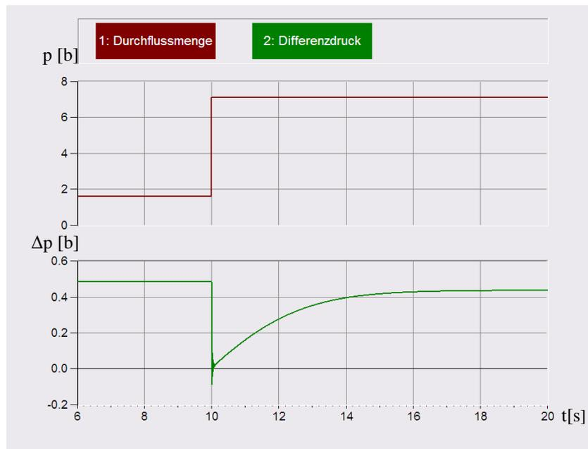
Abb. 8.8: Simulation des Regelverhalten eines ROH's (U 30) bei einer sprunghaften Änderung der Durchflussmenge von  $5,4 \text{ m}^3/\text{h}$
