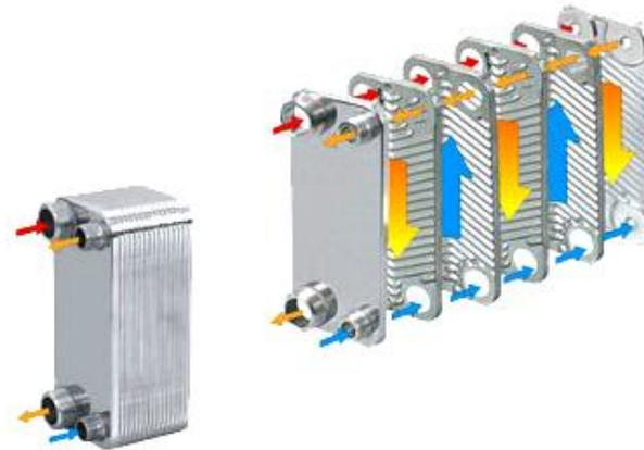
Bild 8.1: Aufbau eines gelöteten Plattenwärmetauschers im Gegenstromprinzip
