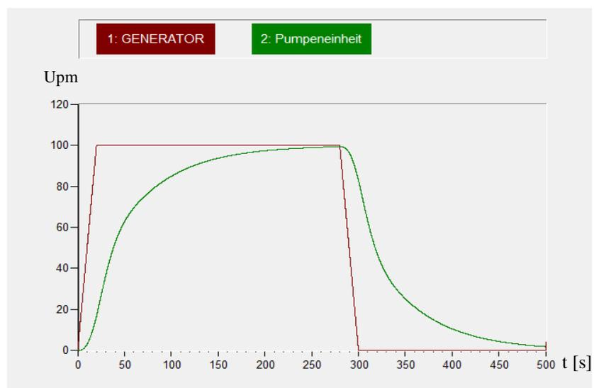
Abb. 11.6: Sprungantwort des Modells der Fernwärmepumpeneinheit bei Sollwertsprung von 100 Upm (Reglereinstellung:  $K_R = 4$  und  $T_n = 25$ )
