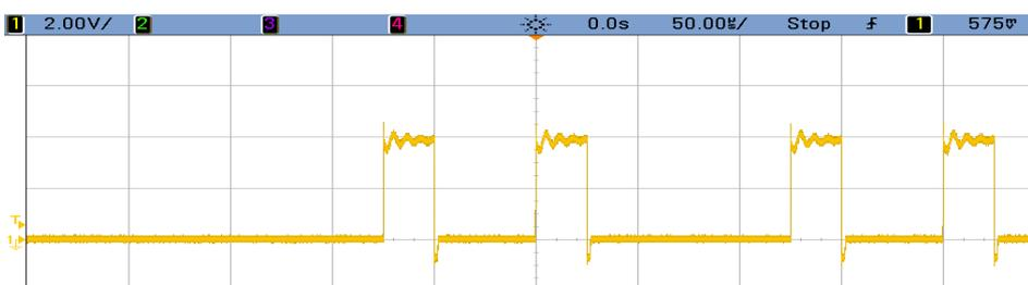
Abbildung 22: Spannungsabfall  $U_{R_1}$  am Basiswiderstand
