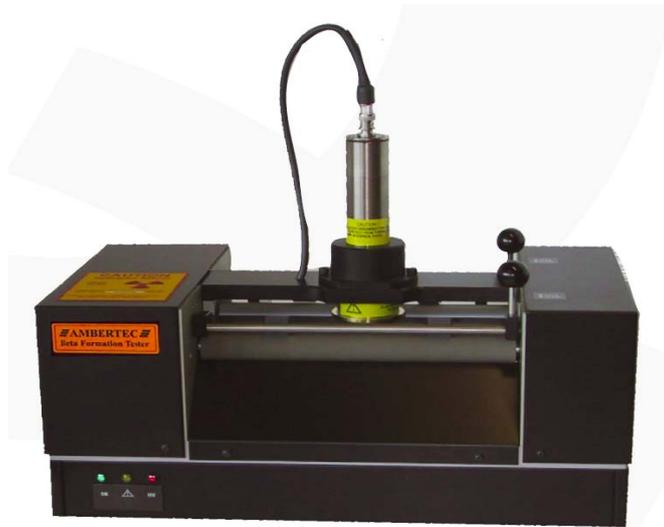
**Abb. 3-4** Ambertec-Beta-Formations-Tester
