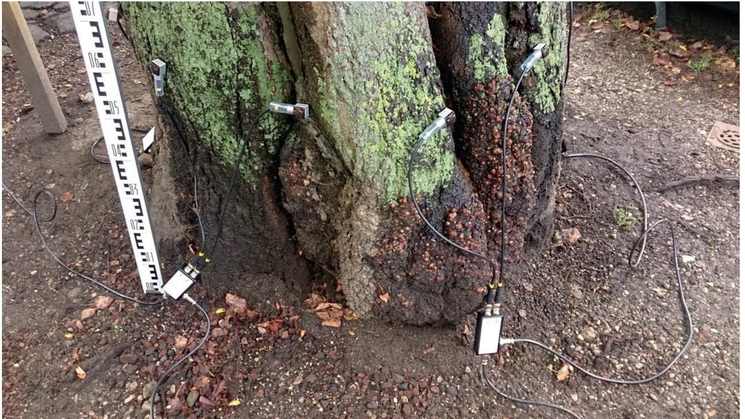
Messaufbau für eine schalltomographische Untersuchung am lebenden Baum.
