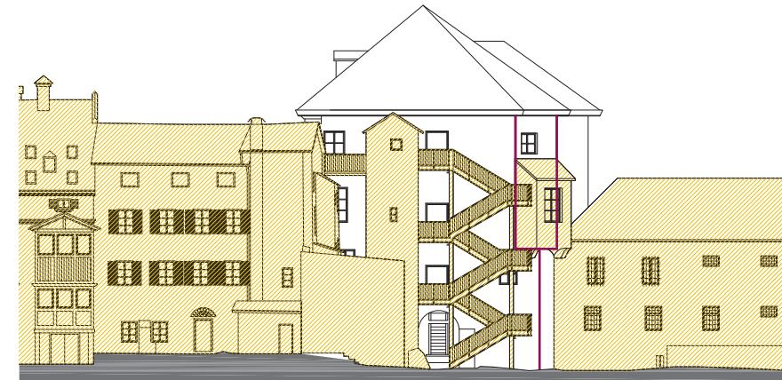
Die Fluchttreppe sowie der schmale Zubau, worin sich je nach Geschöß WCs oder Lagerräume befinden, werden abgebrochen und auf Grund der vorhandenen Kapazität ins Innere des Gebäudes verlagert. Der Erker wird ebenso abgebrochen und die Eck-Kante der unteren Geschößen wird nach oben hin weitergeführt.
