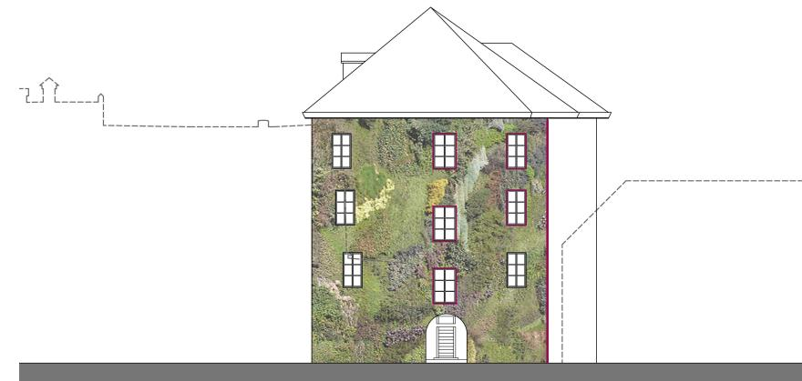
Die Fluchttüren werden durch Fenster ersetzt und an Stelle des Erkers wird die rechte Fensterreihe vervollständigt. Abschließend wird die gesamte Südfassade des Gerichtsgebäudes begrünt.
