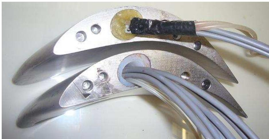
*Abbildung 4-16 Fixierungsausführungen in den Stützstreben*
