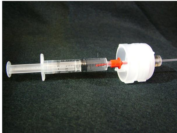
Abbildung 18: Darstellung des Abtrenndevices (Spritze und Filtergehäuse)
