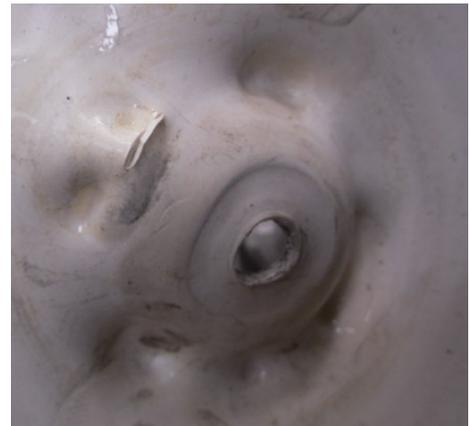
Abb. 5-8: Versagen der Dichtmembran
