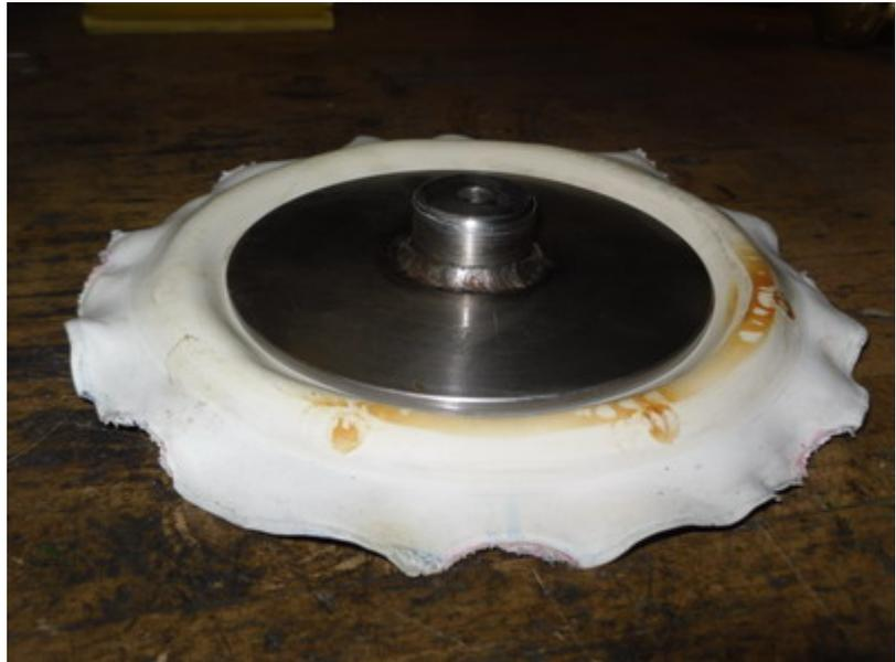
Abb. 7-14: Starke plastische Verformung der Pumpmembran
