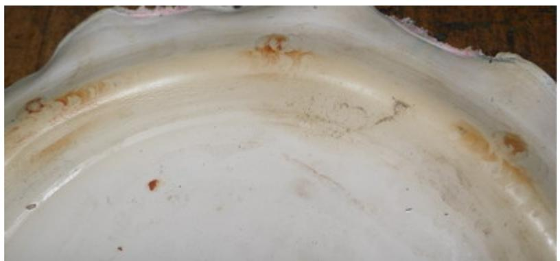
Abb. 7-13: Abdrücke der Wasserauslassbohrungen an der Unterseite der Pumpmembran
