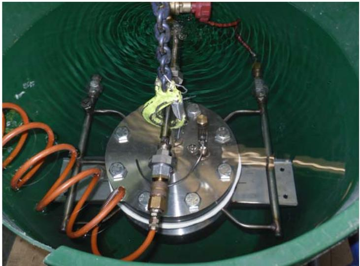
Abb. 5-6: Überprüfung der Dichtheit der Pumpe
