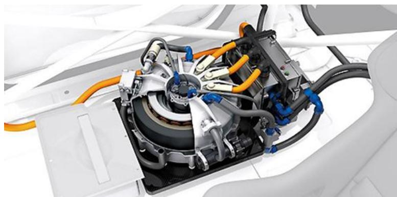
**Abbildung 30: Kinetischer Energiespeicher des Porsche 911 GT3 Hybrids. (28)**
