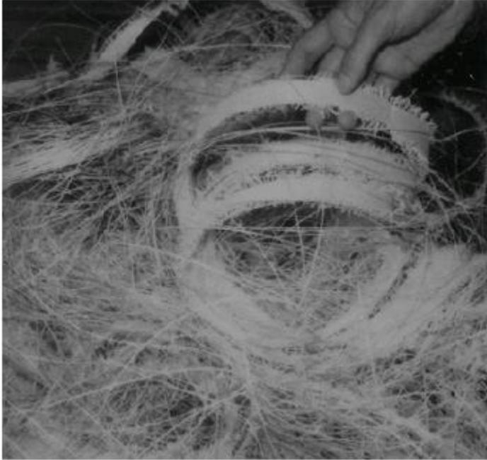
**Abbildung 14: Bruchreste eines Schwungradrotors (3)**
