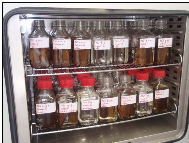
Bild 6-13: Offene und geschlossene Probenflaschen im Alterungssofen
