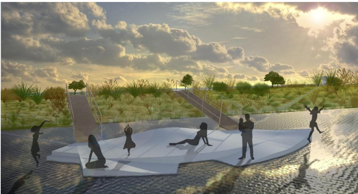
**Abbildung 10.5:** Überarbeitete Schwiminsel mit strömungstechnisch günstiger Form und zwei stabilisierenden Erschließungswegen.
