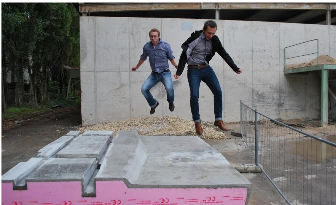
**Abbildung 10.18:** Untersuchung des Tragverhaltens durch Springen auf der Betonhaut.
