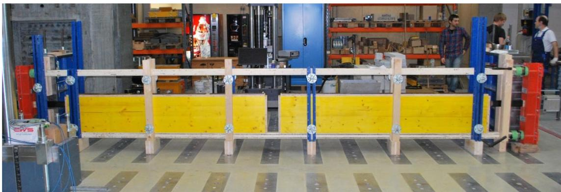
**Abbildung 7.10:** Spannbett-Vorspannung und Schalung des Versuchskörpers.
