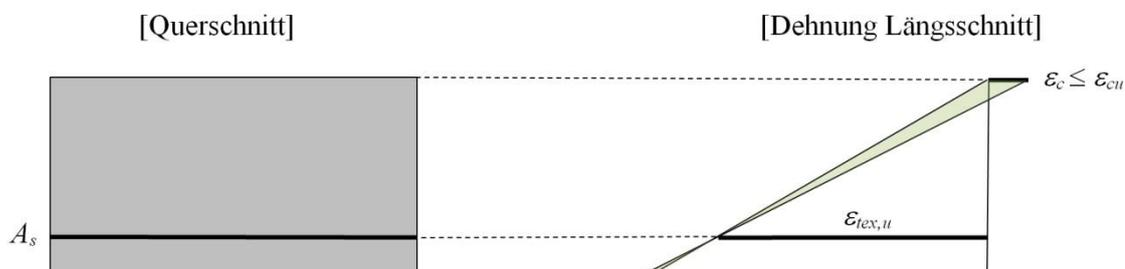
**Abbildung 9.2:** Mögliche Grenzdehnungszustände von Carbonbeton unter Biegebeanspruchung bei Zugzonen-Versagen.
