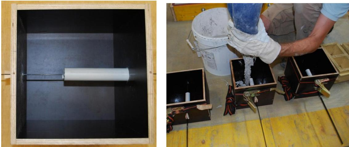
Abbildung 6.3: Schalung Versuchskörper (links) bzw. Betoniervorgang (rechts).
