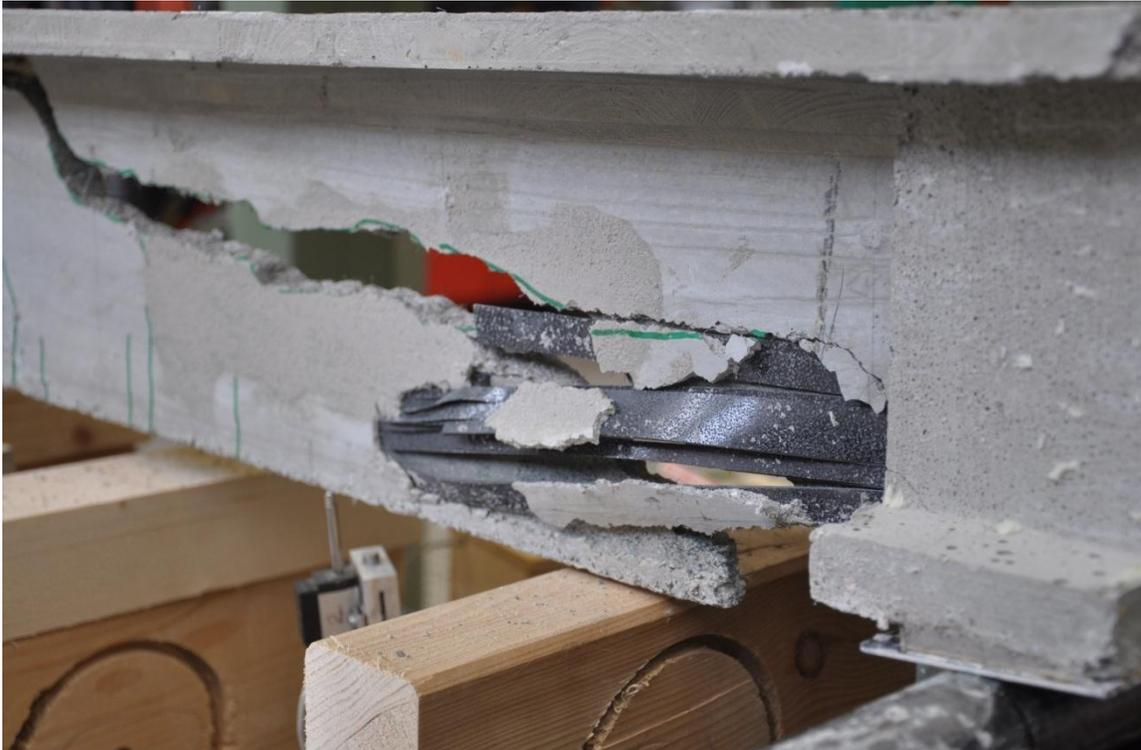
**Abbildung 6.7:** Verbundversagen durch Abscheren der Besandung von der Lamelle.
