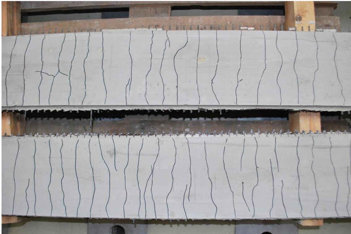
**Abbildung 8.5:** Rissbild der vorgespannten Carbonbeton-Platten nach Durchführung der Versuche.
