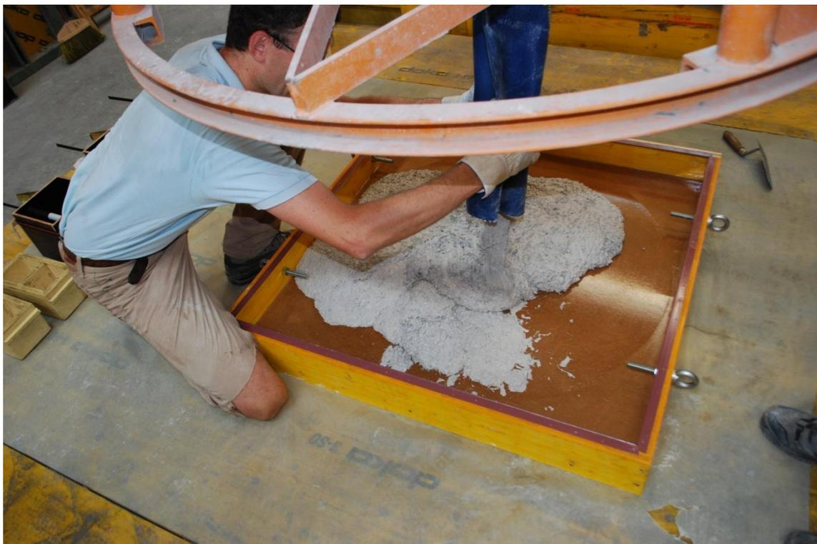
**Abbildung 4.2:** Flüssiger UHPC nach dem Mischvorgang.
