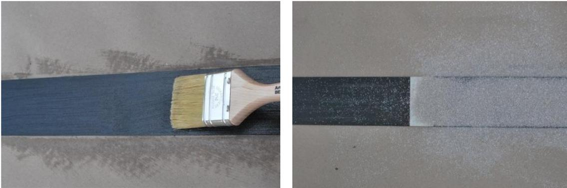
**Abbildung 7.7:** Auftragen der Klebers mittels Pinsel (links) bzw. Einstreuen des Quarzsandes (rechts).
