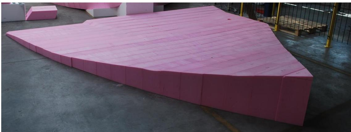
**Abbildung 10.8:** Fertig zugeschnittener Schwimminsel-Ausschnitt.
