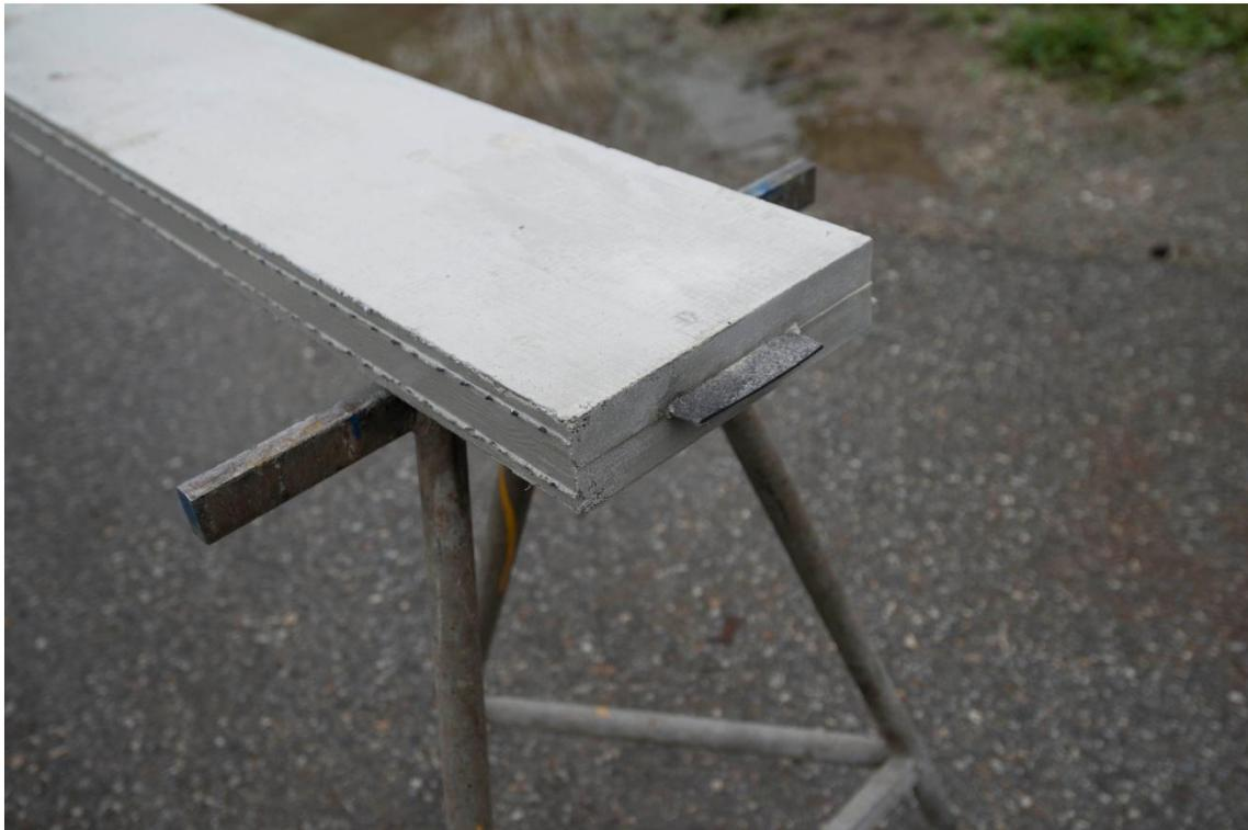
**Abbildung 7.21:** Fertiger Carbonbeton-Plattenstreifen.
