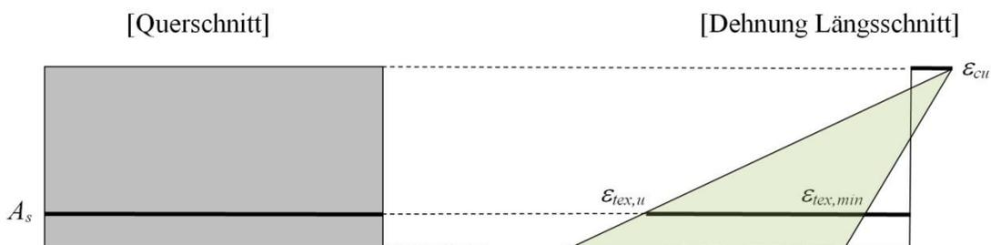
**Abbildung 9.3:** Mögliche Grenzdehnungszustände von Carbonbeton unter Biegebeanspruchung bei Druckzonen-Versagen.
