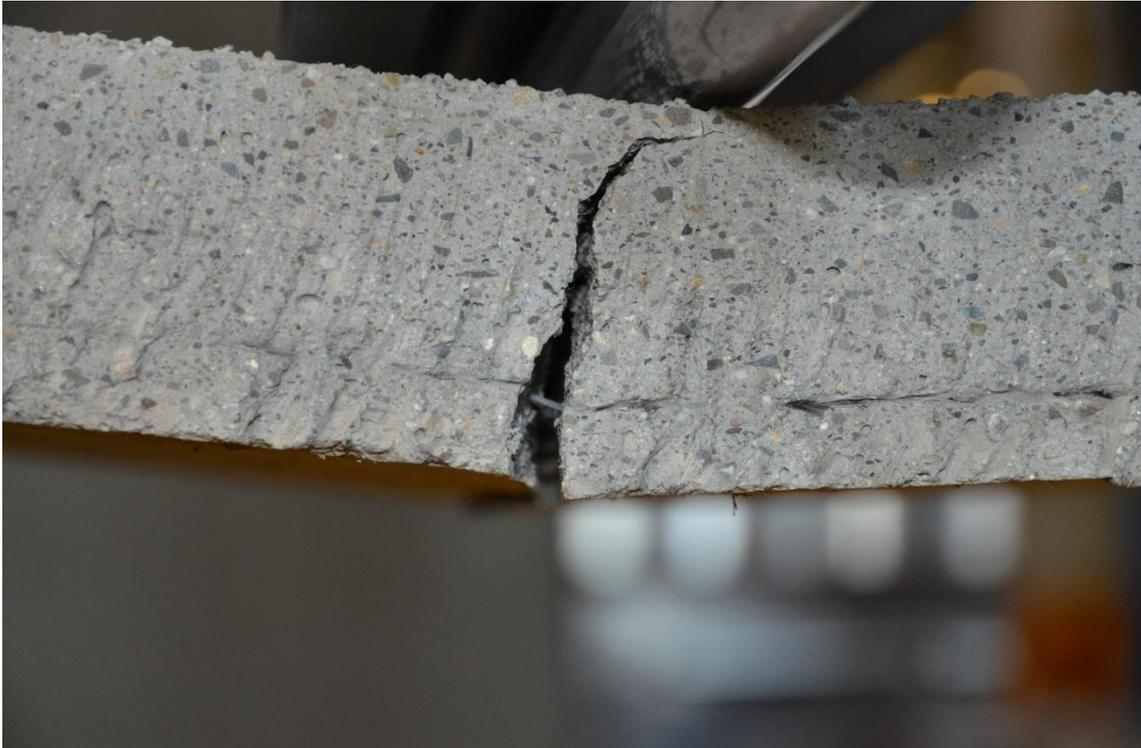
Abbildung 10.15: Versagensart der Biegeversuche.
