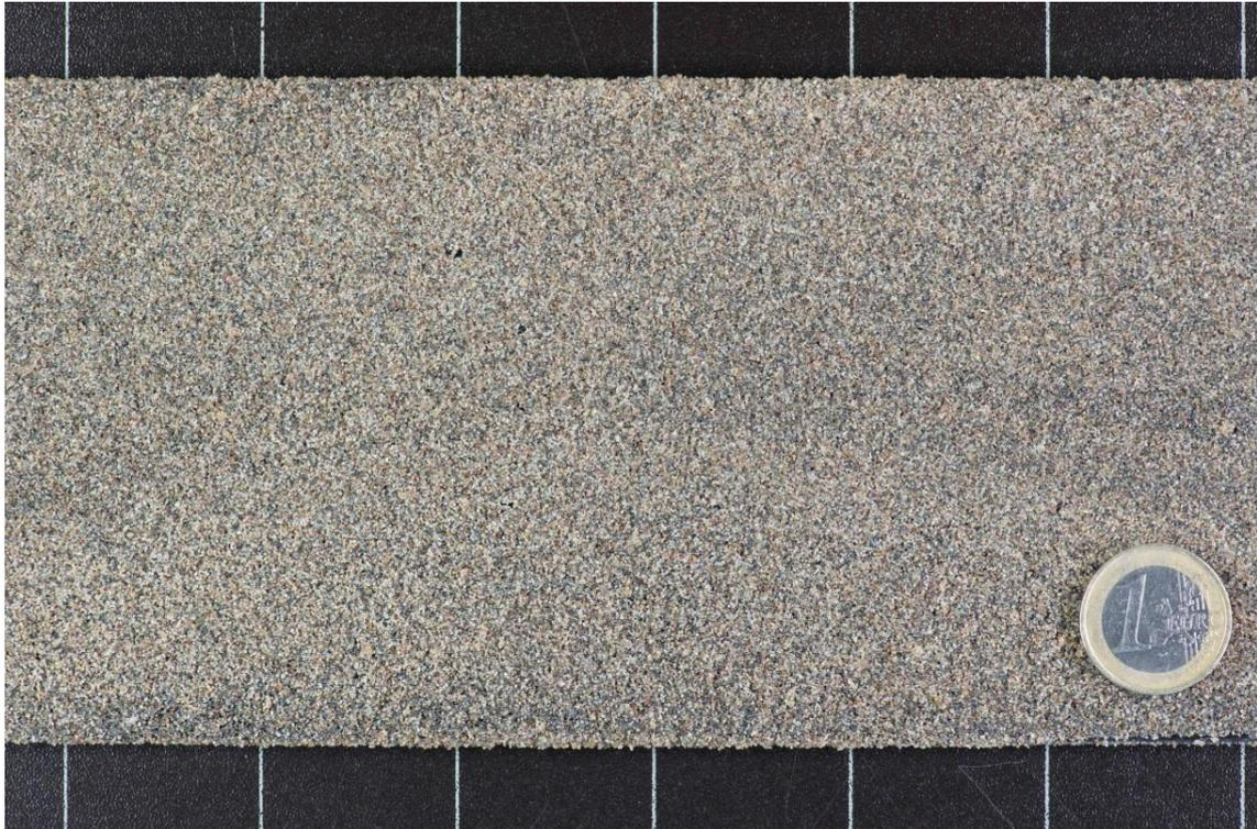
**Abbildung 6.2:** Oberfläche einer besandeten CFK-Lamelle.
