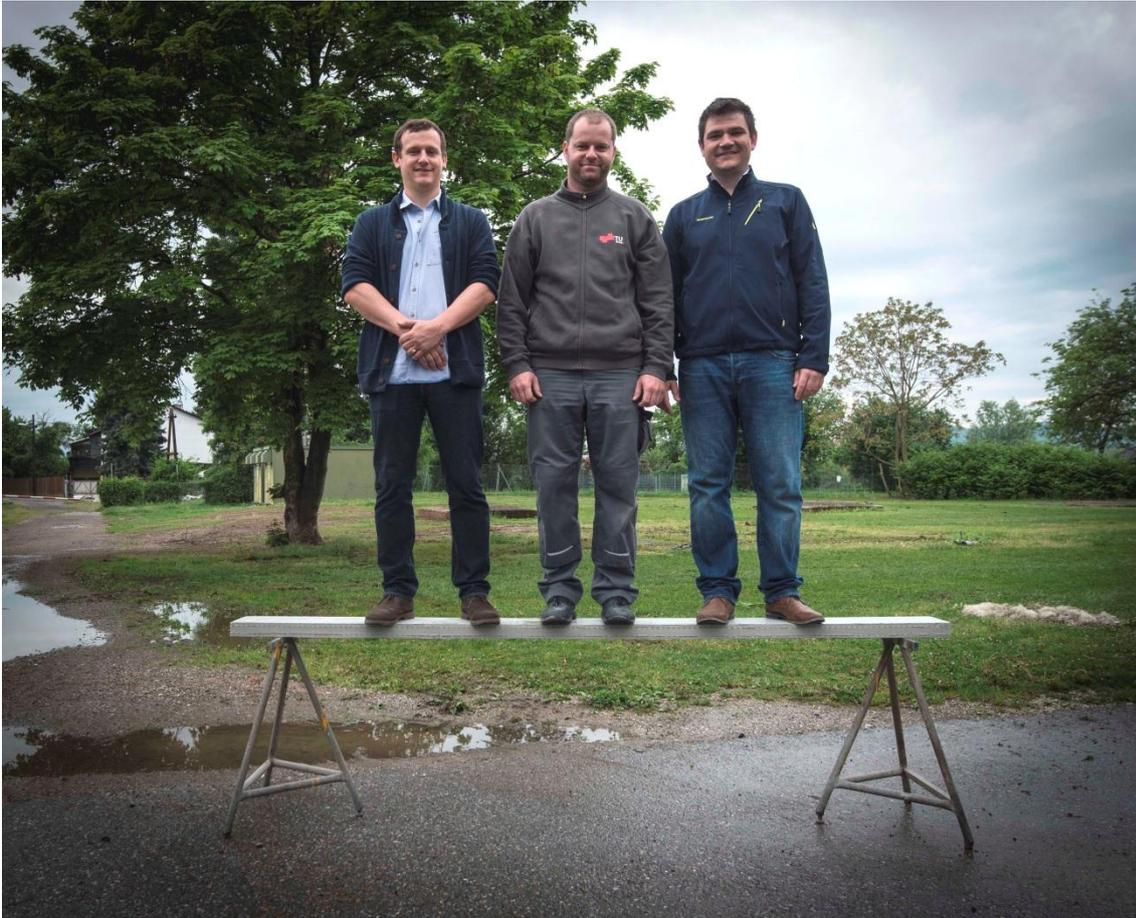
Abbildung 8.7: Tragverhalten der vorgespannten Platten unter Personenlast.
