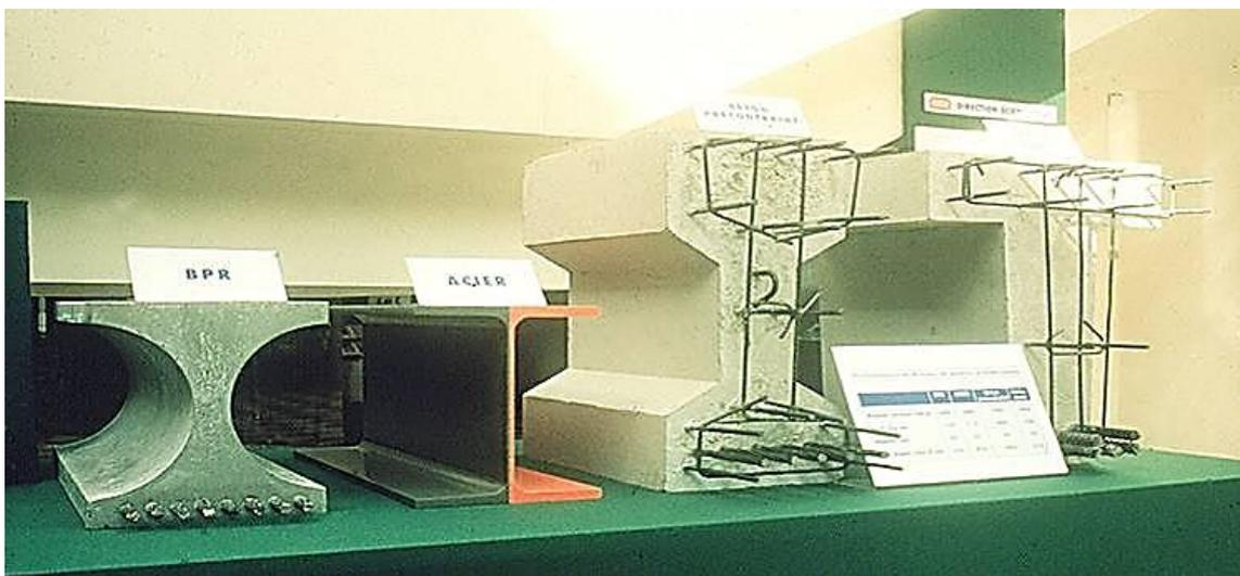
**Abbildung 4.4:** Vier Träger gleicher Momenten-Tragfähigkeit aus UHPC, Stahl, Spannbeton und Stahlbeton (von links nach rechts).<sup>17</sup>
