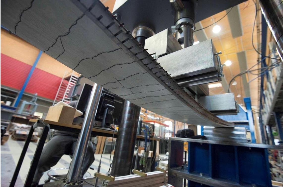
**Abbildung 8.6:** Abgeschlossenes Rissbild der vorgespannten Carbonbeton-Platten.
