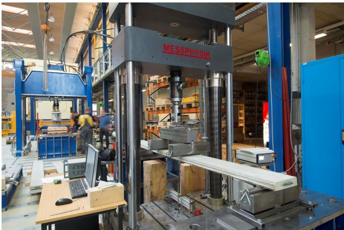
Abbildung 8.1: Versuchsaufbau 4-Punkt Biegeversuche.
