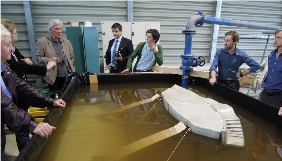
**Abbildung 10.6:** Modellversuch im Maßstab 1:10 zur Beurteilung des Schwimminsel-Verhaltens bei einem Wasserspiegelanstieg von 7,0 m.
