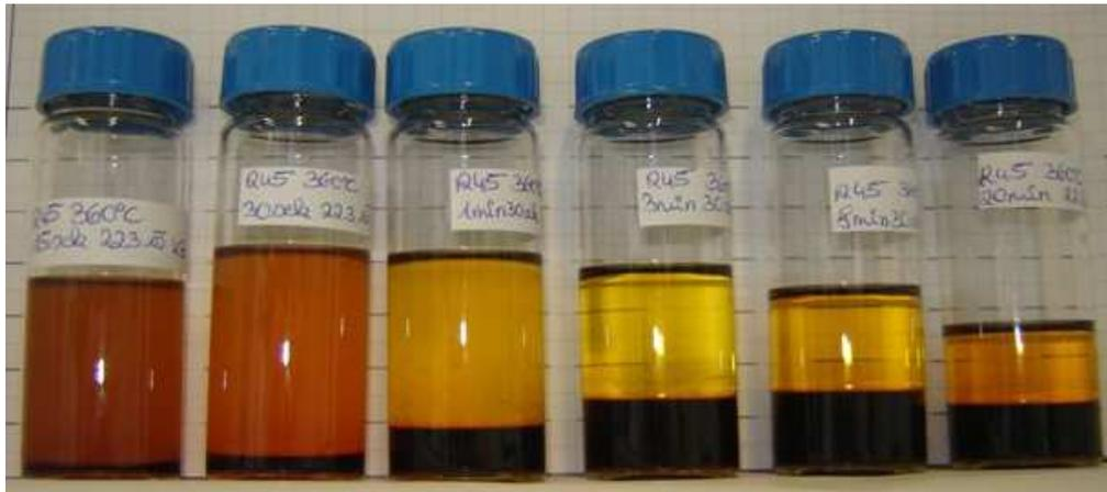
Abbildung 86: Zeitlicher Verlauf der Produktbildung an Kondensierbarem zur Bestimmung des Verhältnisses zwischen wässriger und öliger Phase ( $T_R = 360$  [°C],  $T_{BH} = 200$  [°C], VGO, Holzspäne atro).
