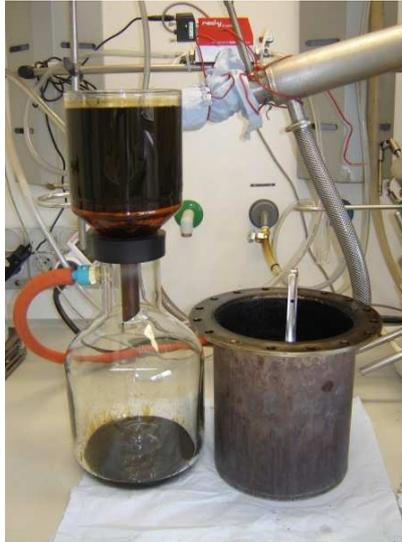
Abbildung 38: Filtration des Wärmeträgeröl-Kohle-Gemisches
