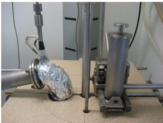
Abbildung 34: Biomassezugabeschleuse und Begleitheizung
