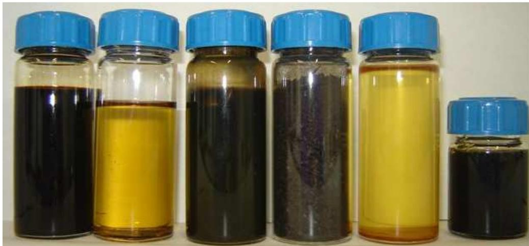
Abbildung 37: Produkte (von links nach rechts: wässrige Phase, ölige Phase, gebrauchtes Wärmeträgeröl, Kohle, Produktöl und geschlepptes Wärmeträgeröl)
