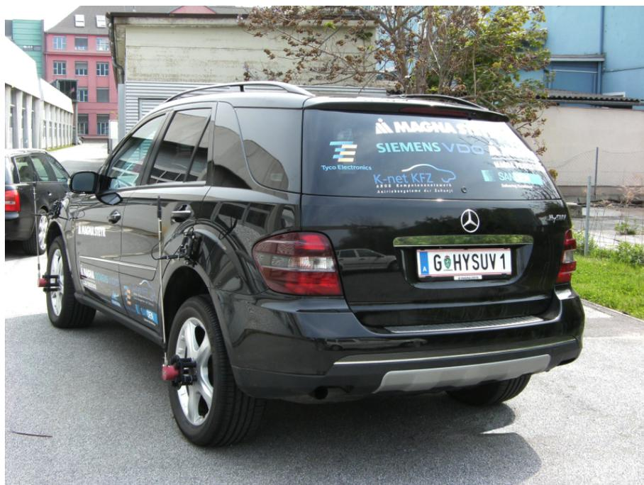
Abbildung 3.26: Der Versuchsträger mit Schleifringabnehmern
