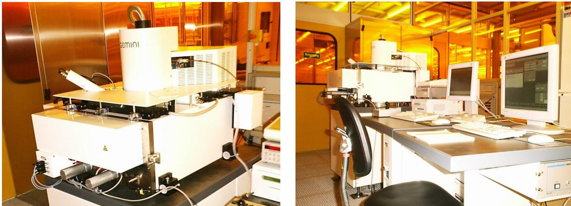
**Abbildung 3.10:** Der Raith 200 Chip-Scanner. Die für die Arbeit verwendeten REM Bilder wurden mit einem Raith 200 Chipscanner erzeugt. Dieser besteht aus einem REM, einem im Nanobereich verstellbaren Probetisch und einem Laserinterferometer zur Bestimmung der absoluten Position des Probetisches. In Verbindung mit einer vorhergehenden Kalibrierung ist es möglich, eine Chipebene automatisch und verzerrungsfrei abzubilden.
