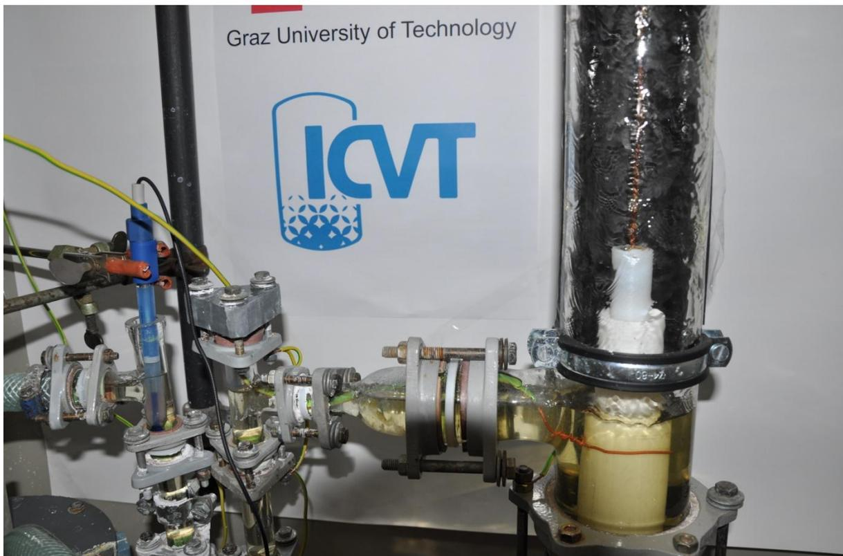
Abbildung 5-4: Gelbfärbung der Waschlösung durch gelöstes Stickstoffdioxid
