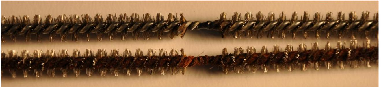
Abbildung 4-3: Vergleich einer neuen Elektrode mit einer gealterten, Betriebsstundenanzahl unbekannt
