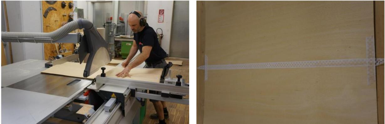
**Abbildung 118: Zuschnitt der Furniere mit der Kreissäge und gefügte Querlage**
