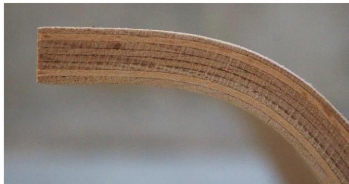
*Abbildung 52: formgepresstes Sperrholz aus 1,5 mm starken Buchenfurnieren mit 2 Querlagen*
