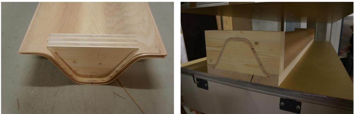
*Abbildung 122: "Querschot" und außen aufgeklebte Auflagerverstärkung*
