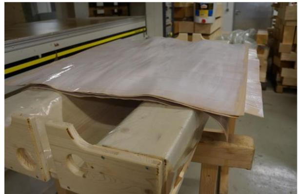
*Abbildung 82: Klebstoffauftrag und Schichten der Furniere*
