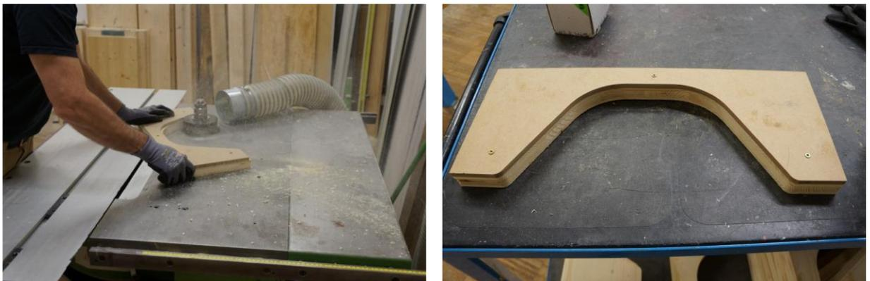
*Abbildung 114: Fräsvorgang mittels Kopiervorrichtung und fertig gefrästes Grundelement der Form*
