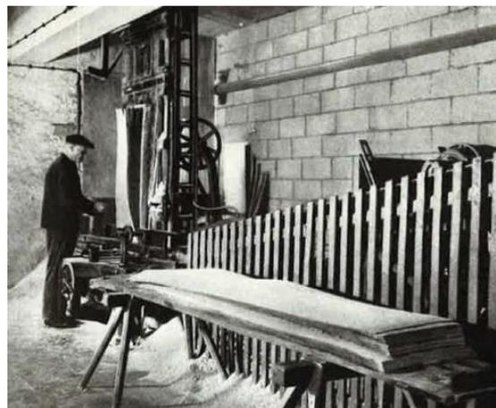
**Abbildung 18: Furnier-Gattersäge in Betrieb. Der Lattenverschlag verdeckt den Kurbeltrieb zwecks Unfallverhütung (Kollmann; 1962)**
