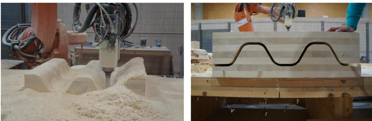
Abbildung 80: Fräsvorgang für die zweiwellige Matrize und fertige Pressform
