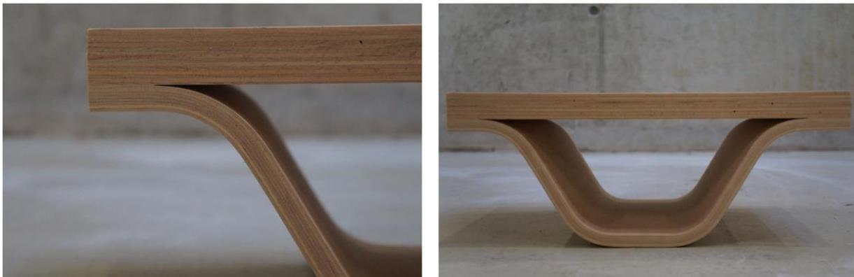
*Abbildung 93: einwelliges Profil mit Deckplatte aus Buchensperrholz*
