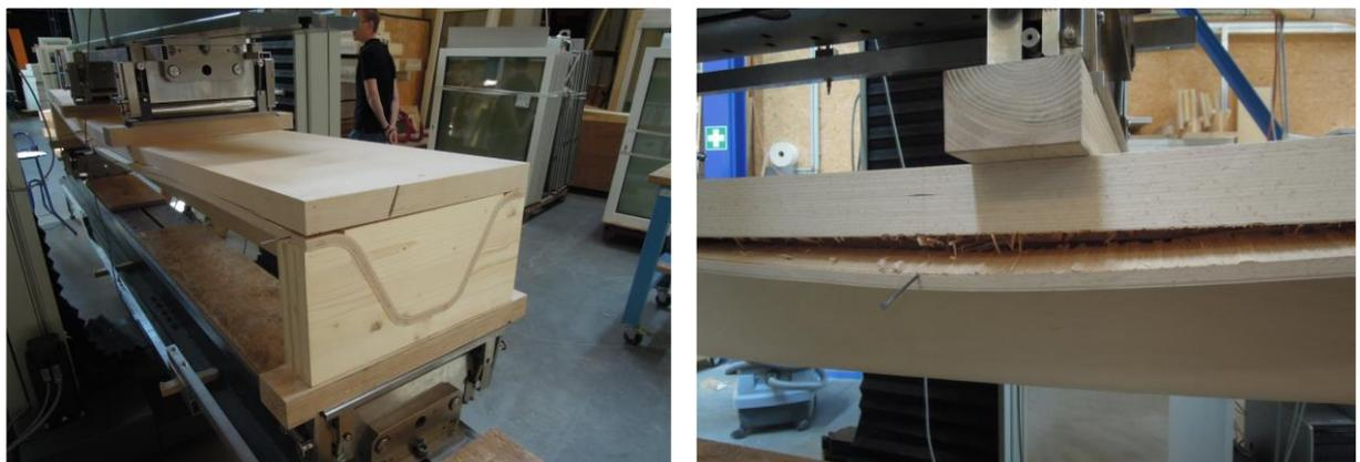
*Abbildung 133: Versagen des Trägers an der "Nordseite"*
