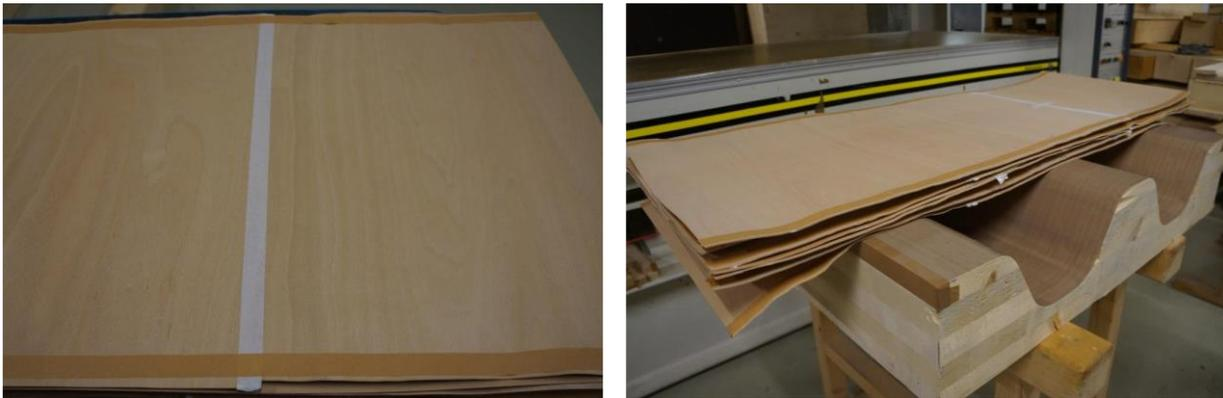
*Abbildung 86: gefügte und verstärkte Furniere*
