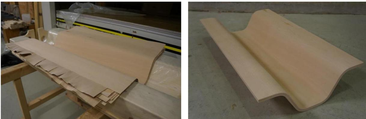
*Abbildung 81: Prototyp 1 einwellig nach dem Pressvorgang und nach dem Zuschneiden*
