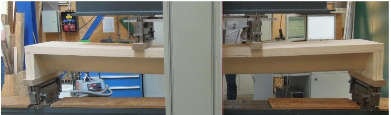
*Abbildung 132: Träger kurz vor Erreichen der Maximallast*
