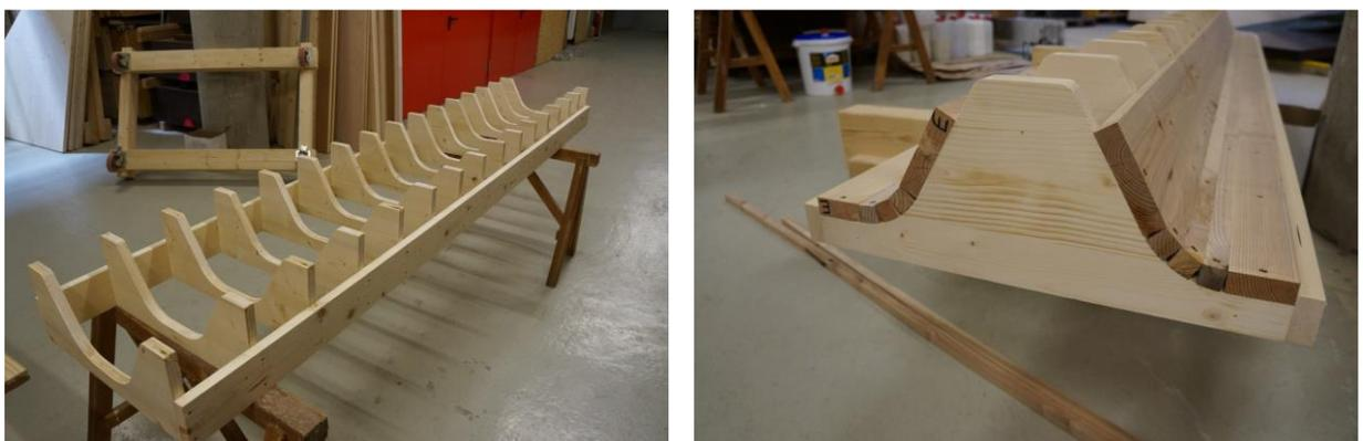
*Abbildung 115: Grundgerüst und bereits zum Teil aufgeschraubte Eschenbretter bzw. -leisten*
