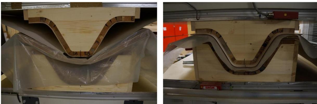
Abbildung 120: offene und geschlossene Presse mit Form
