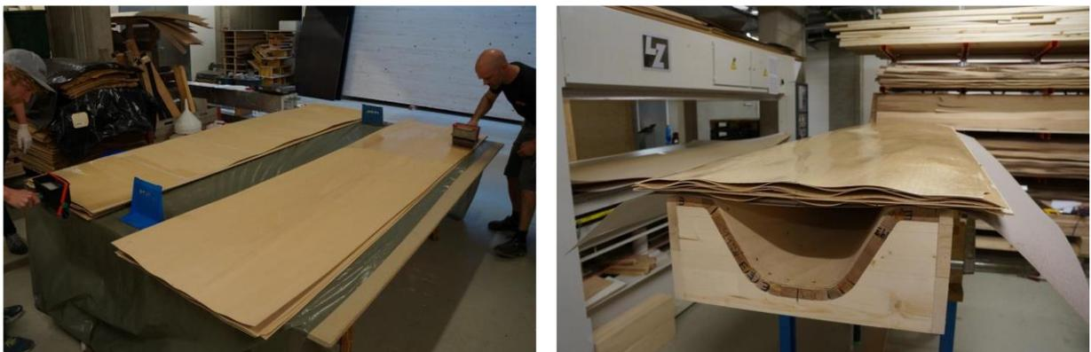
**Abbildung 119: Klebstoffauftrag und auf der Matrize aufgelegte, mit Kleber versehene Furnierlagen**
