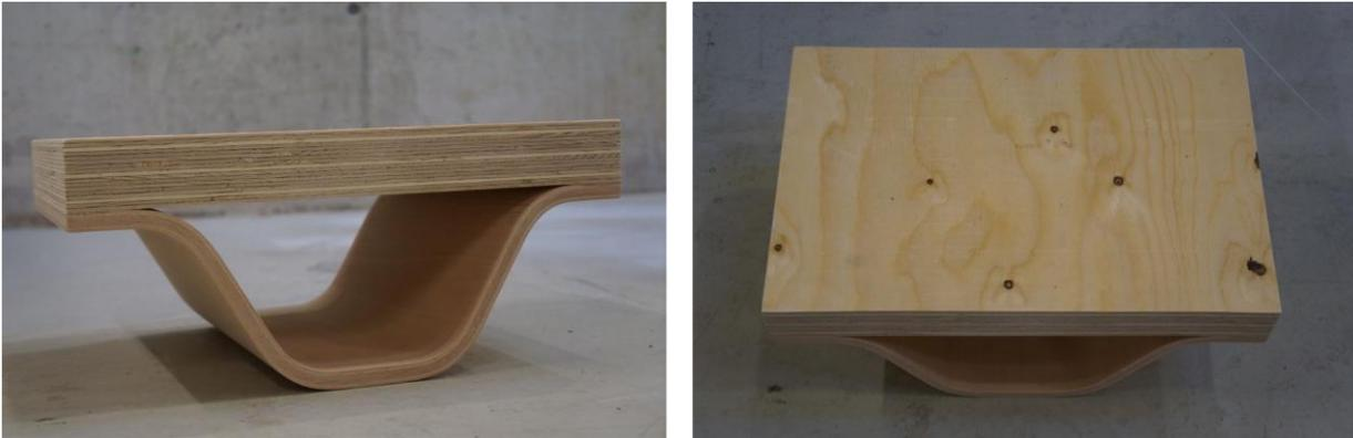
*Abbildung 92: einwelliges Profil mit Deckplatte aus Kerto Q*
