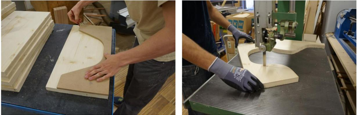
*Abbildung 113: Übertragen der Schablonenform auf die Fichtenplatten und grobes Zuschneiden mit der Bandsäge*
