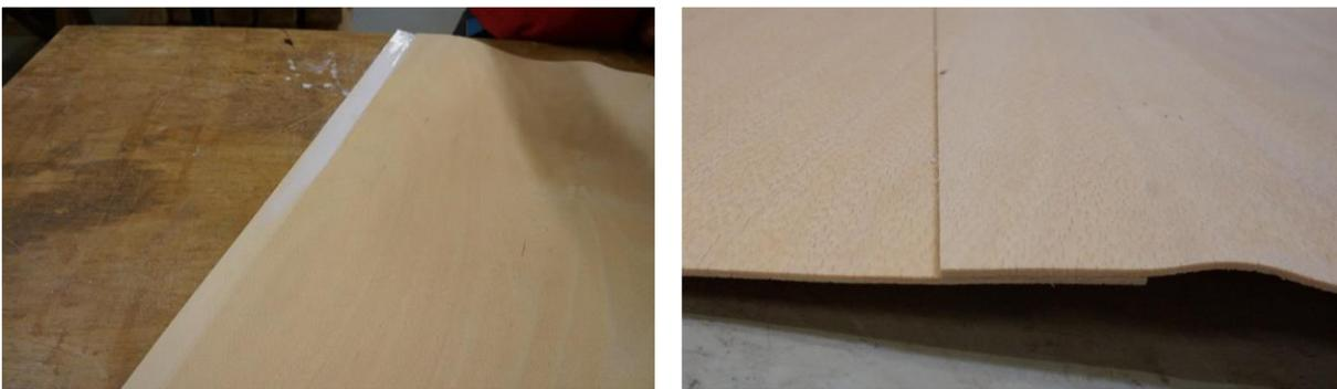
**Abbildung 90: mit Klebstoff versehener Stoß und fertige Verbindung nach dem Pressen**
