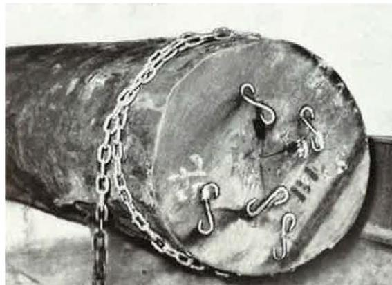
**Abbildung 12: Eisenklammern zur Verhütung von Endrissen a) Bügelform b) C-Klammer c) S-Klammer und Anordnung von S-Klammern im Rundholz (Kollmann; 1962)**
