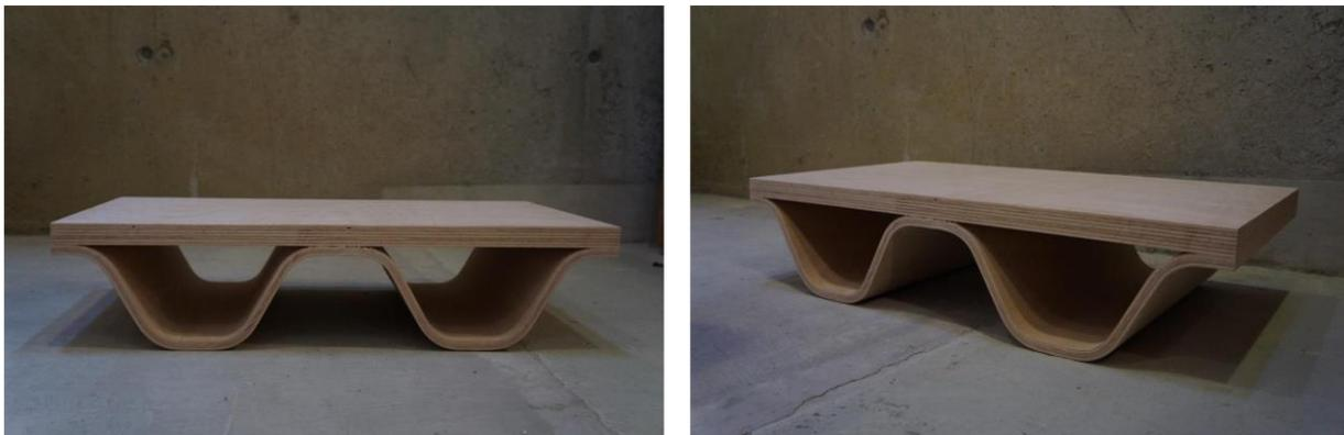
*Abbildung 94: zweiwelliges Profil mit Deckplatte aus Buchensperrholz*
