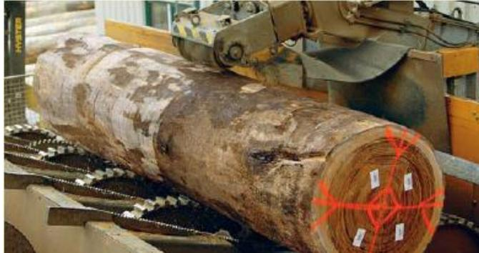
**Abbildung 11: Entrindungsvorgang mittels Fräse (Danzer Europe Veneer)**
