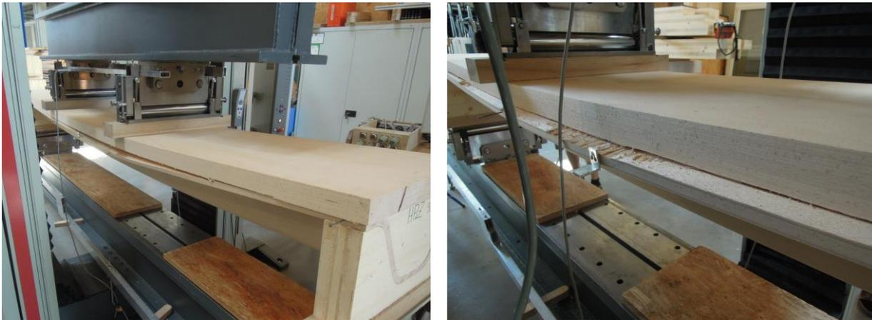
Abbildung 134: Versagen des Trägers an der "Südseite"
