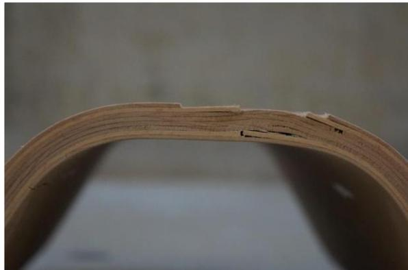
**Abbildung 89:** *Detailaufnahme des gerissenen Bereichs*
