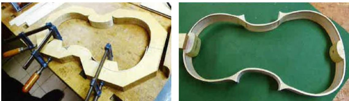
*Abbildung 39: Zargenaußenform und fertige Zarge einer Geige (Fiwek; 2011)*
