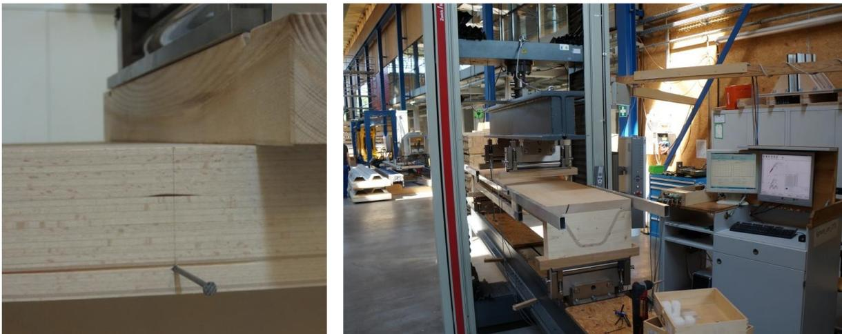
Abbildung 129: Nagel zur Aufhängung des Messgestänges und Darstellung des gesamten Prüfaufbaus
