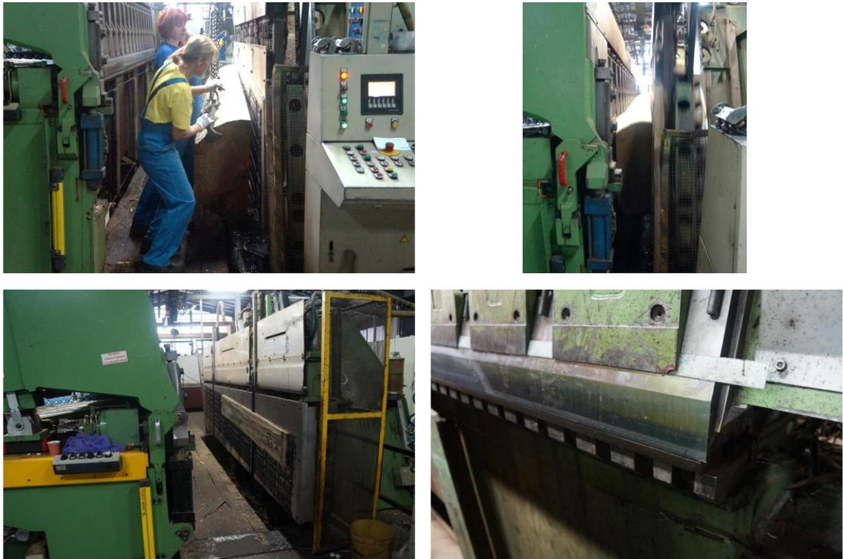
**Abbildung 26: Einheben eines Blockes, Messervorgang beim senkrechten Furniermessern, Restbohle auf Unterdruckhalterung, Messer- und Druckbalken**
