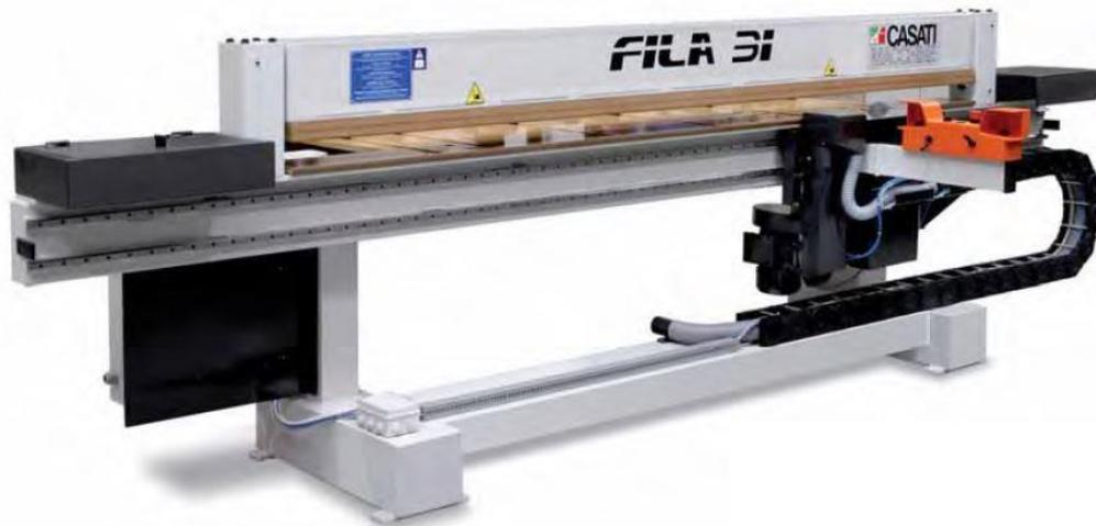
*Abbildung 19: Furnier- und Plattensäge mit Nachfräsaggregat Typ FILA (Casati Maschine; 2000)*
