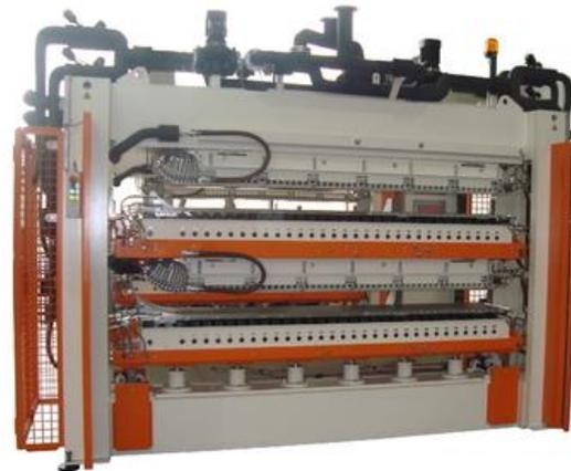
**Abbildung 56:** Hochfrequenz-Schichtkiverleimanlage aus dem Jahr 1957 (Sandweg; 1957) und moderne Skipresse für Alpinski mit einer Gesamtpresskraft von 900 kN (Langzauner Composite Pressen)
