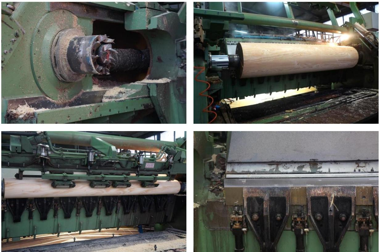
**Abbildung 32: Spindel mit zurückfahrbarer Außenklaue und angeschälter Rundholzstamm, Restbohlen mit zusätzlicher Abstützung und Werkzeugschlitten mit Messer- und Druckbalken**
